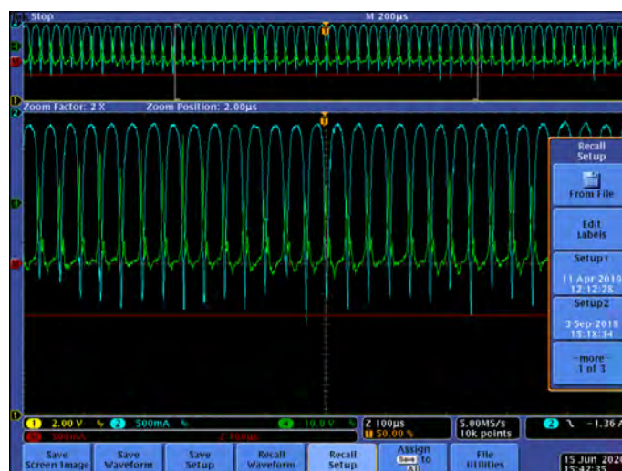
Rysunek 3.18: Przykładowy zrzut ekranu oscyloskopu używanego podczas eksperymentu przeprowadzanego z silnikiem KLIMT przy U_d = 540 \text{ V} . Kolor niebieski obrazuje przebieg prądu wyładowania, zielony potencjału pływakowego.
