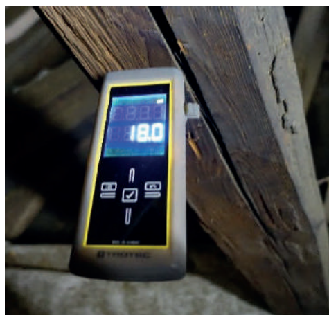
Rys. 45. Wyniki pomiaru wilgotnościomierzem T510: a) storczyk – wilgotność 17,7%, b) zastrzał – wilgotność 18%
