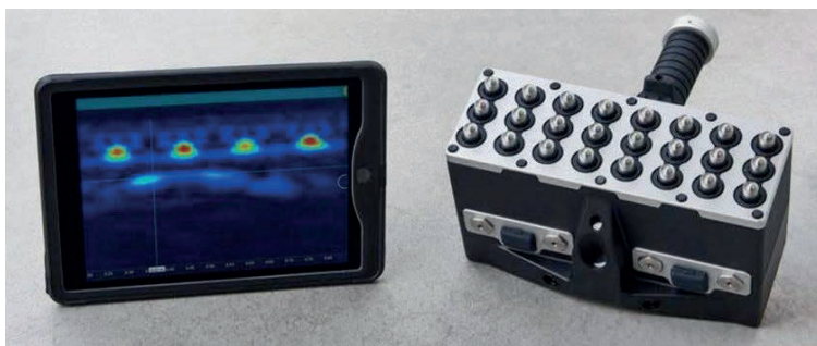
Rys. 39. Tomograf ultradźwiękowy Pundit Pd 8000
