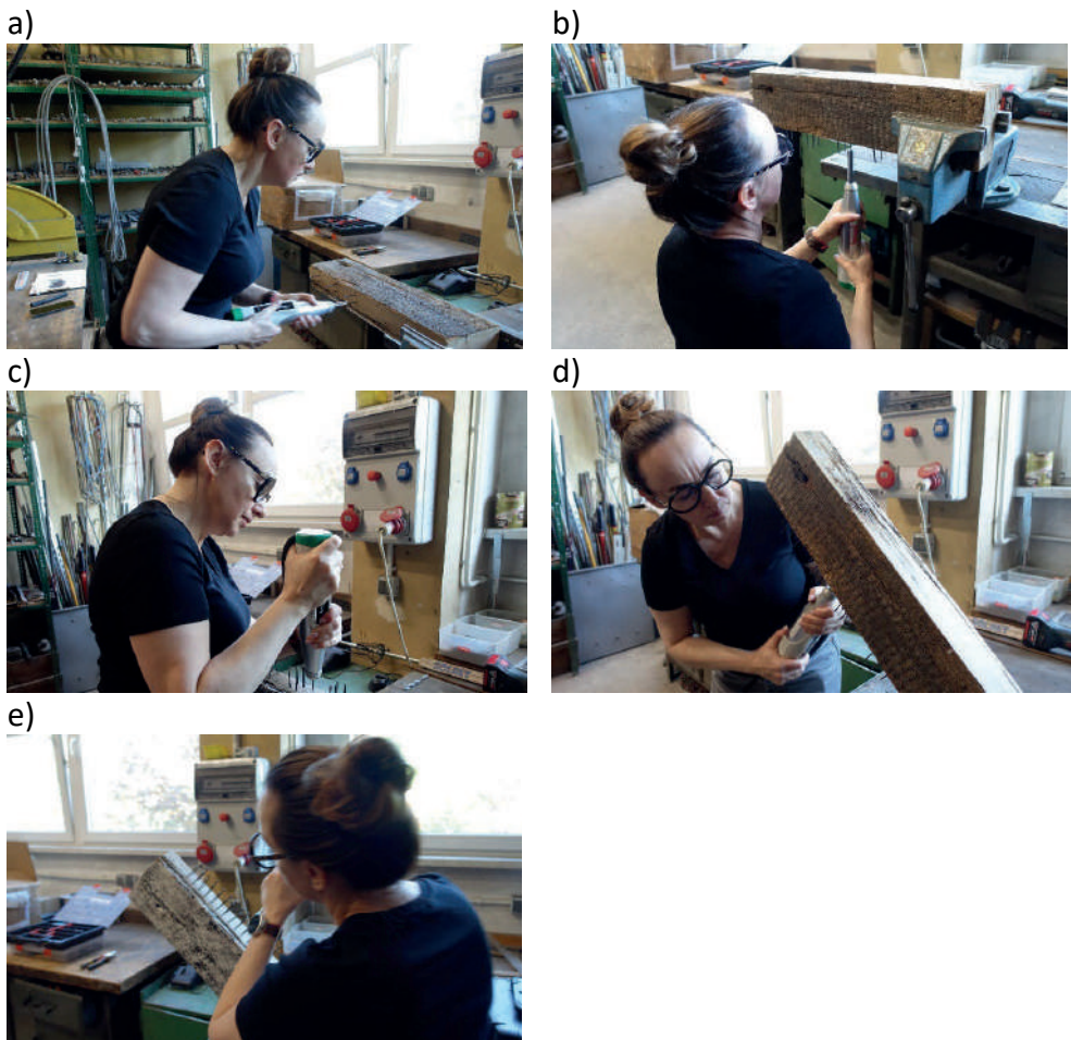
Rys. 69. Badania do wyznaczenia współczynnika poprawkowego z uwagi na położenie młotka (element dębowy): a) położenie poziome, b) położenie pionowo w górę, c) położenie pionowo w dół, d) położenie pod kątem 45° w górę, e) położenie pod kątem 45° w dół
