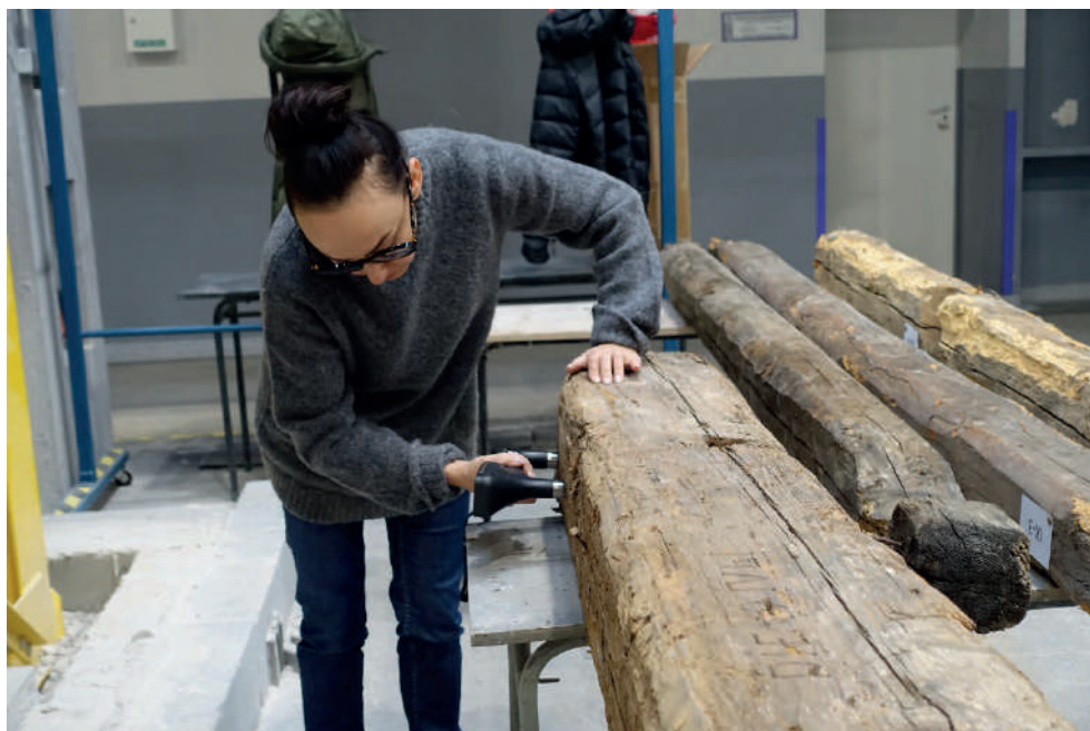
Rys. 73. Badanie belki urządzeniem UK 1401 SURFER
