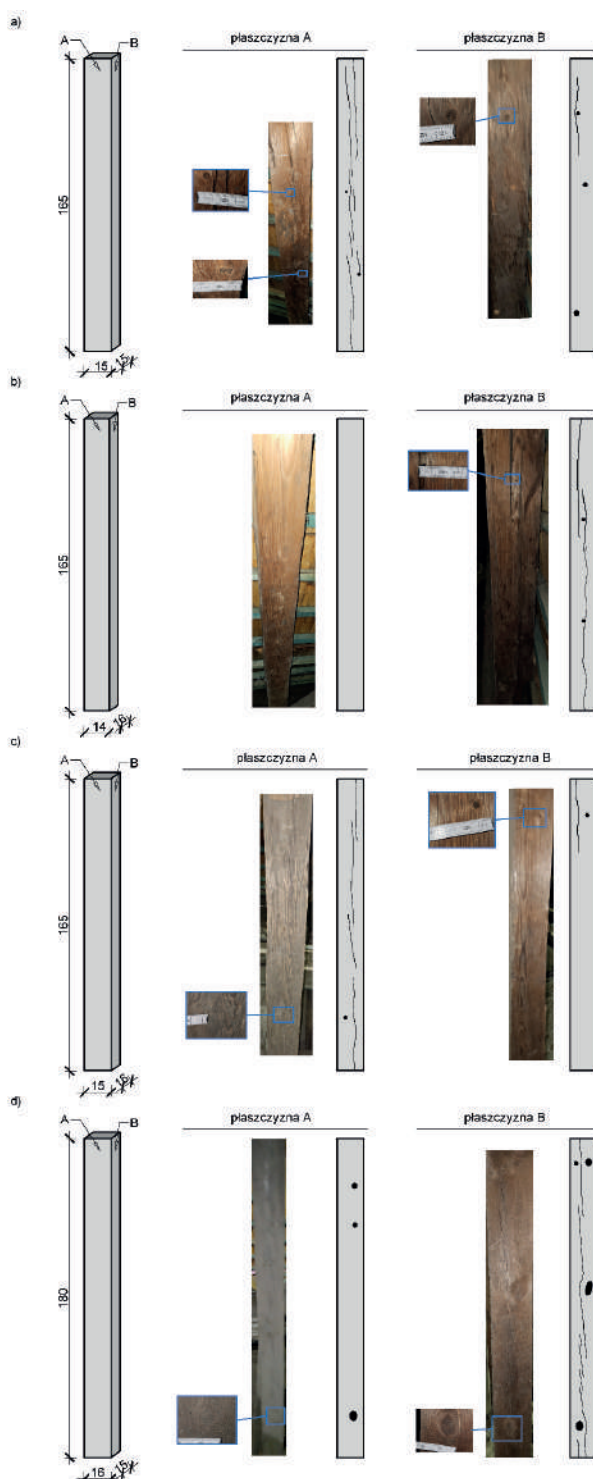
Rys. 38. Inwentaryzacja badanych elementów z więźby nad nawą
