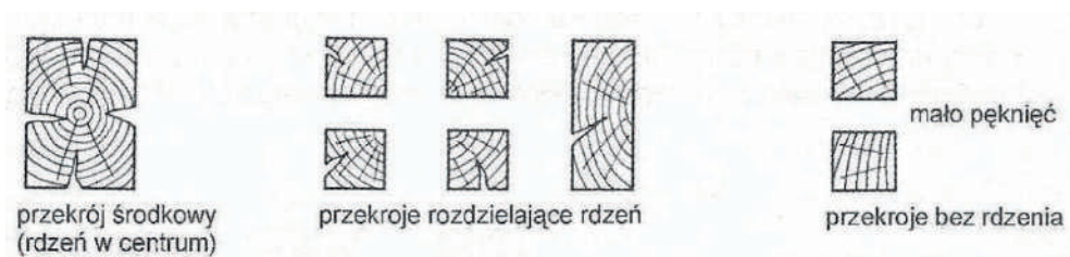
Rys. 4. Wpływ przetarcia na lokalizację pęknięć [77]
