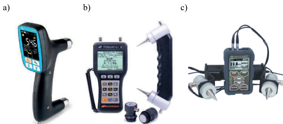
Rys. 12. Przykładowe urządzenia ultradźwiękowe z głowicami eksponencjalnymi: a) UK1401 Surfer, b) Pulsar-2.1, c) Novotest IPSM
