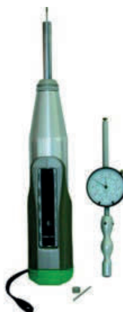
Rys. 15. Przykładowe młotki do drewna: a) DRC Młotek Schmidta do drewna, b) Woodtester
