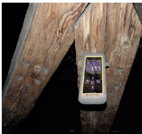
Rys. 45. Wyniki pomiaru wilgotnościomierzem T510: a) storczyk – wilgotność 17,7%, b) zastrzał – wilgotność 18%
