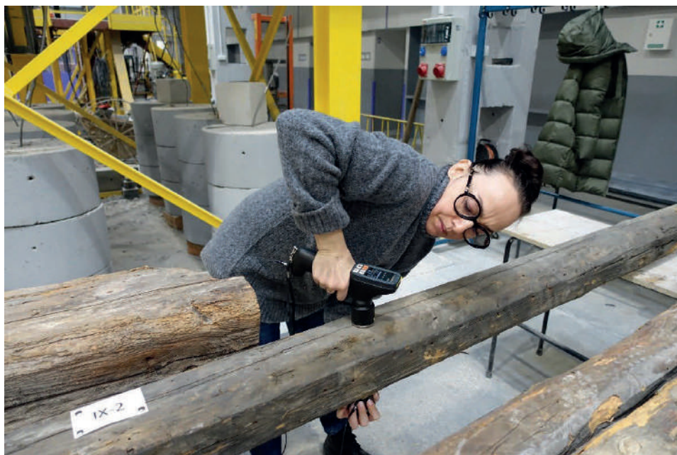
Rys. 74. Badanie belki urządzeniem UK 1410 PULSAR
