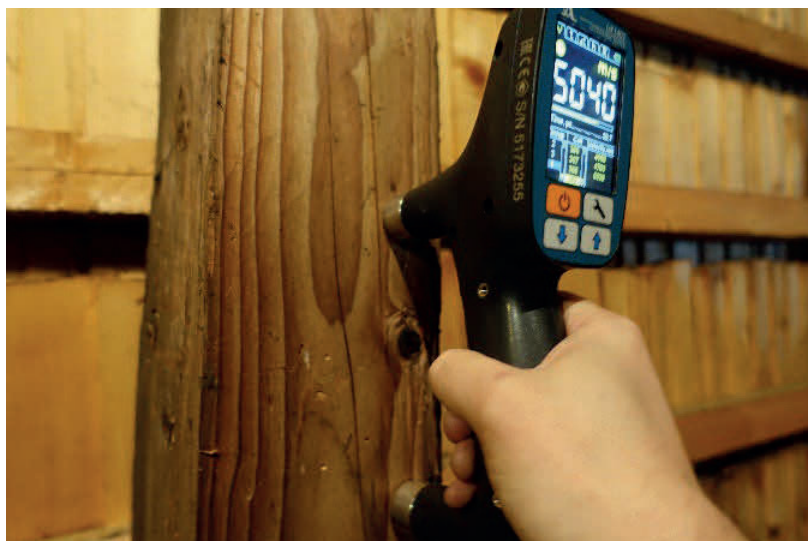
Rys. 43. Badanie urządzeniem UK1401 Surfer
