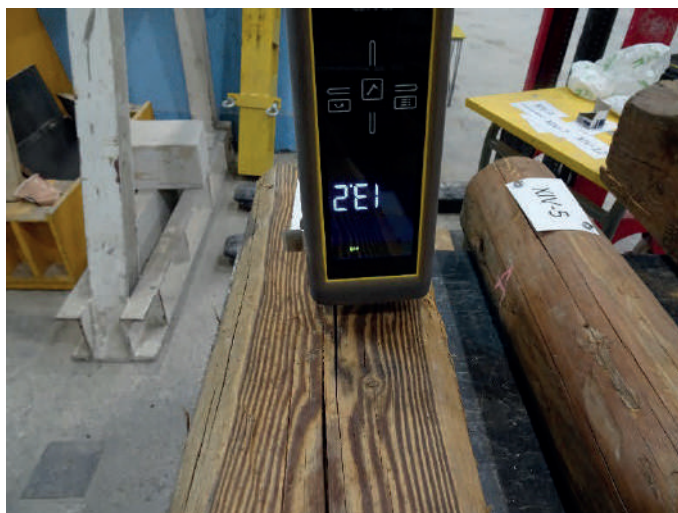
Rys. 65. Przykładowy pomiar wilgotności
