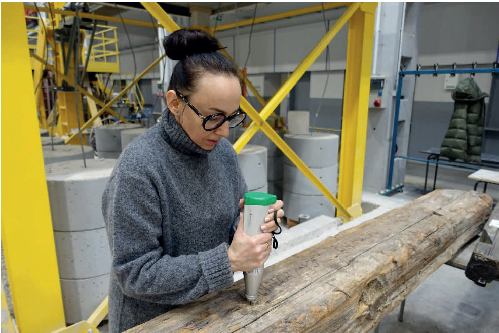
Rys. 72. Badanie belki młotkiem do drewna
