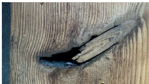
Rys. 2. Przykłady sęków: a) żywiczny, b) zepsuty, c), wypadający, d) skrzydlaty, e) koncentracja sęków, f) wypadający
