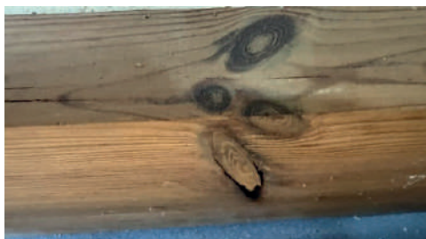
Rys. 2. Przykłady sęków: a) żywiczny, b) zepsuty, c), wypadający, d) skrzydlaty, e) koncentracja sęków, f) wypadający
