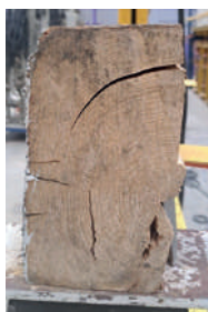
Rys. 5. Przykłady pęknięć zabytkowej tarcicy: a) Kościół św. Józefa w Sadowie (XV w.), b) Kościół Matki Boskiej Śnieżnej w Mikołowie (XVI w.), c) duży spichlerz w Toruniu (XVIII w.), d) Suszarnia browarów książęcych w Tychach (XIX w.) e) belki z kościoła Świętej Trójcy w Turośni Kościelnej (XVIII w.), f) Wieżba zamku Kapituły Warmińskiej w Olsztynie (XIV w.)
