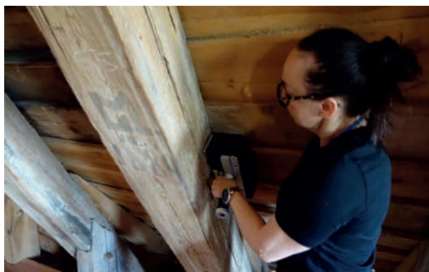
Rys. 106. Badanie tomografem ultradźwiękowym na więźbie północnej zamku w Olsztynie
