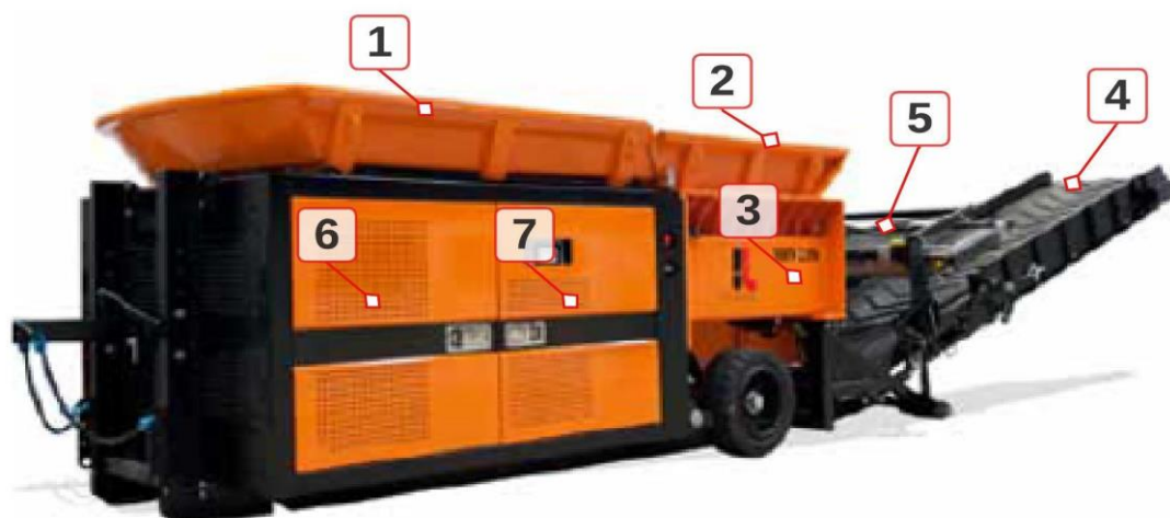
Fot. 2. Mobilny dwuwałowy rozdrabniacz MRW 2.85H (1 - wanna zasypowa, 2 - wały rozdrabniające – 2 szt., 3 - belka przełamująca, 4 - taśmociąg odprowadzający uzyskany materiał, 5 - separator metali żelaznych, 6 - układ napędowy, 7 - pulpit sterowniczy)
