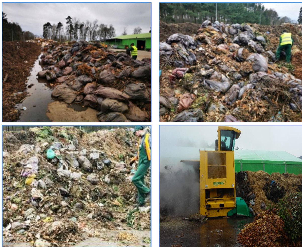
Fot. 1. Manualne usuwanie zanieczyszczeń ze strumienia bioodpadów dostarczanych na instalację oraz proces formowania pryzm przez przerzucarkę
