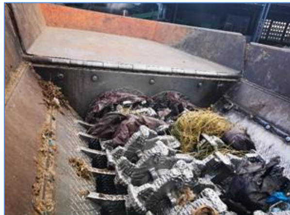
Fot. 3. Dwuwałowy rozdrabniacz PRONAR MRW 2.85H: A– wanna zasypowa, B – wały rozdrabniające
