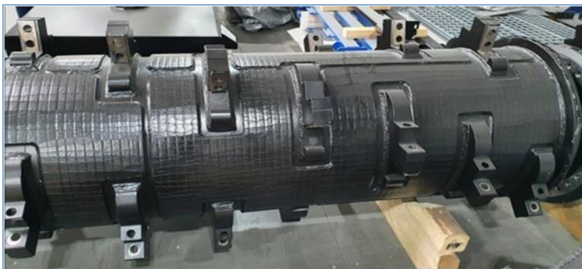
Fot. 8. Wał rozdrabniający wyposażony w noże Multi Grip
