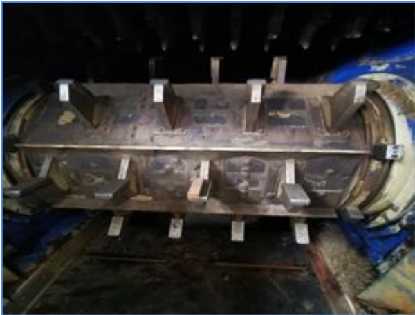
Fot. 11. Rozrywarka worków Matthiessen: A – proces załadunku ładowarką; B - przenośnik łańcuchowy z widocznymi zgarniaczami; C – układ rozrywający; D - materiał po przejściu przez układ rozrywający
