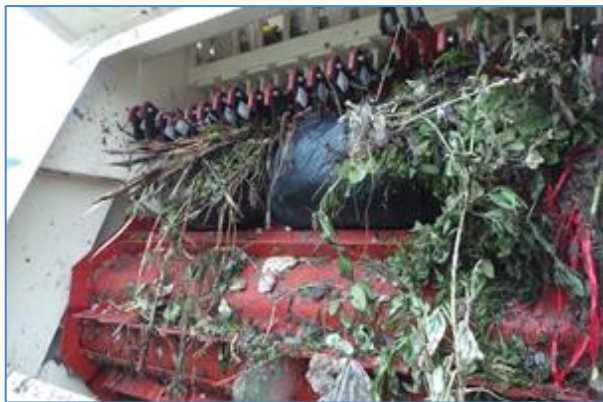
Fot. 4. Rozrywarka worków LIS: A - układ rozrywania worków, B - przenośnik sortowniczy
