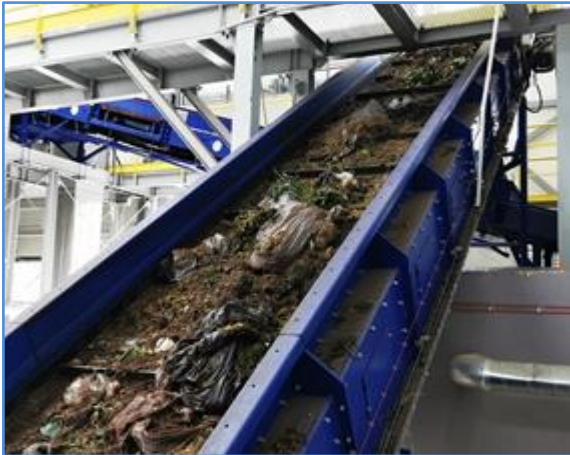
Fot. 11. Rozrywarka worków Matthiessen: A – proces załadunku ładowarką; B - przenośnik łańcuchowy z widocznymi zgarniaczami; C – układ rozrywający; D - materiał po przejściu przez układ rozrywający
