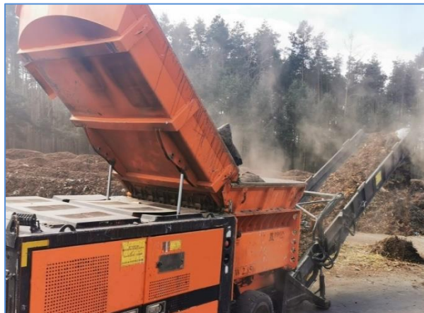
Fot. 3. Dwuwałowy rozdrabniacz PRONAR MRW 2.85H: A– wanna zasypowa, B – wały rozdrabniające
