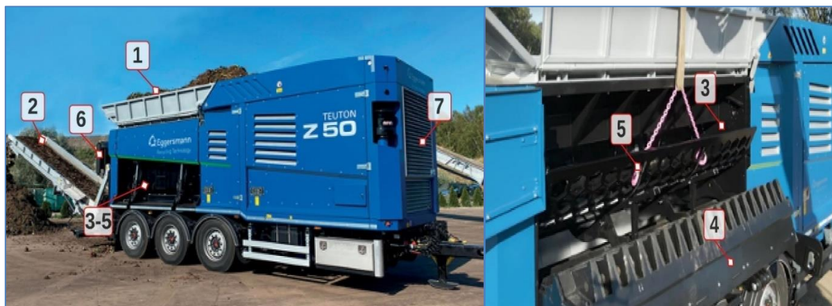
Fot. 7. Mobilny rozdrabniacz jednowałowy TEUTON Z50 (1 - komora załadunkowa, 2 - przenośnik taśmowy, 3 - wał rozdrabniający, 4 - grzebień przeciwny, 5 - system wymiennych koszy sitowych, 6 - separator metali żelaznych, 7 - układ sterowania)
