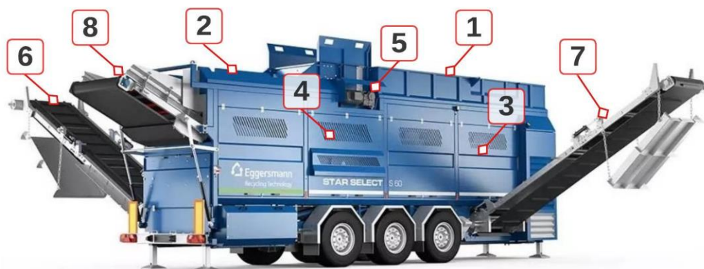
Fot. 5. Mobilny przesiewacz gwiaździsty STAR SELEKT S60 (1 - komora załadunkowa, 2 - przenośnik taśmowy, 3 - pokład gwiaździsty gwiazd dużych, 4 - pokład gwiaździsty gwiazd małych, 5 - rolka klasyfikacyjna, 6 - taśmociąg odprowadzający uzyskany materiał, 7 - taśmociąg odprowadzający frakcję strukturalną, 8 - taśmociąg odprowadzający zanieczyszczenia)
