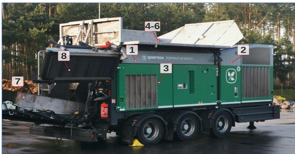
Fot. 9. Budowa mobilnego rozdrabniacza jednowałowego TERMINATOR 5000S (1 - komora załadunkowa, 2 - wysokoprężny układ napędowy, 3 - hydrauliczny napęd wału rozdrabniającego, 7 - przenośnik taśmowy wyładowczy, 8 - separator metali żelaznych, 9 - układ sterowania)
