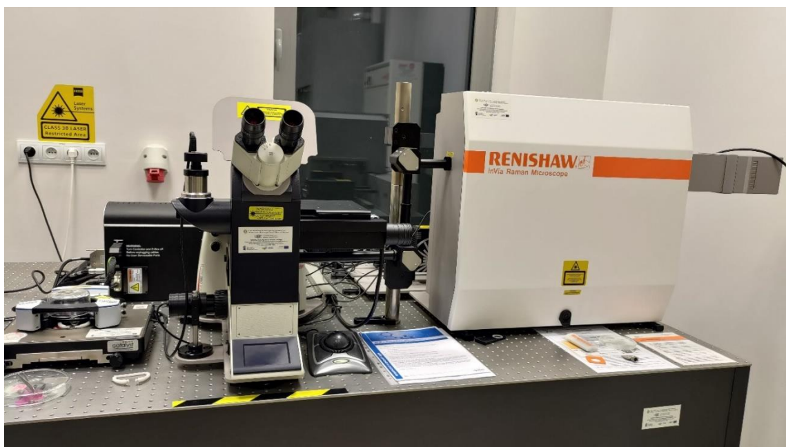
Rys. 10 Spektroskop Ramanowski inVia Renishaw Laboratorium Skaningowej Mikroskopii Próbnikowej w Centrum Innowacji: Technologie dla Zdrowia Człowieka Parku Naukowo-Technologicznego Uniwersytetu Zielonogórskiego Sp z o. o.
